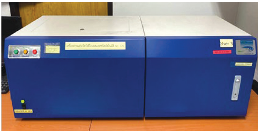
ภาพที่ 4 เครื่องอ่านแผ่นวัดรังสีโอเอสแอลชนิดอัตโนมัติ
