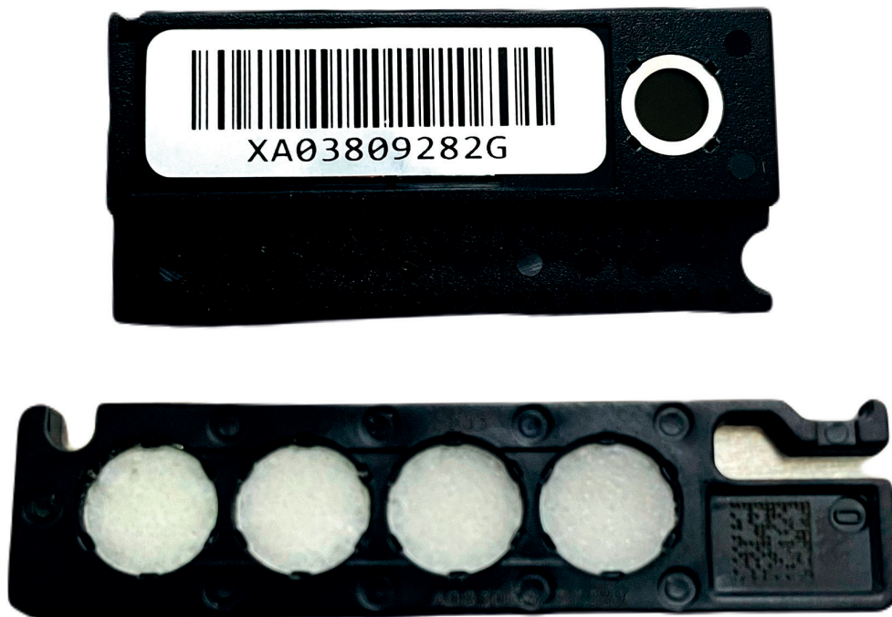
ภาพที่ 1 แผ่นวัดรังสี OSL ชนิด InLight® Basic (4)
