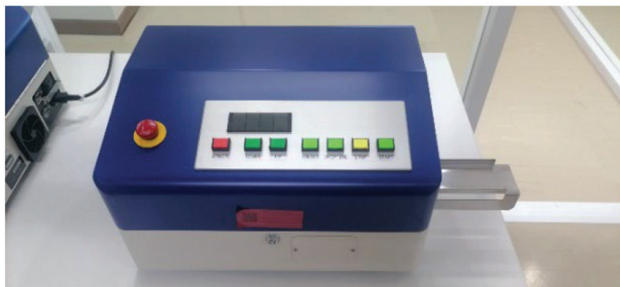
ภาพที่ 3 เครื่องล้างสัญญาณโอเอสแอลชนิดอัตโนมัติ
