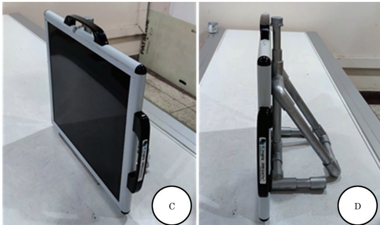
ภาพที่ 8 การทดสอบประสิทธิภาพและความปลอดภัยของอุปกรณ์ช่วยยึดแผ่นรับภาพขณะใช้และไม่ใช้กริด
