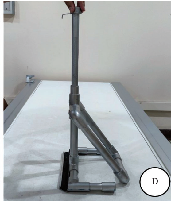
ภาพที่ 7 อุปกรณ์ช่วยยึดแผ่นรับภาพขณะเอกซเรย์โดยใช้ลำรังสีแนวราบ ดังนี้
