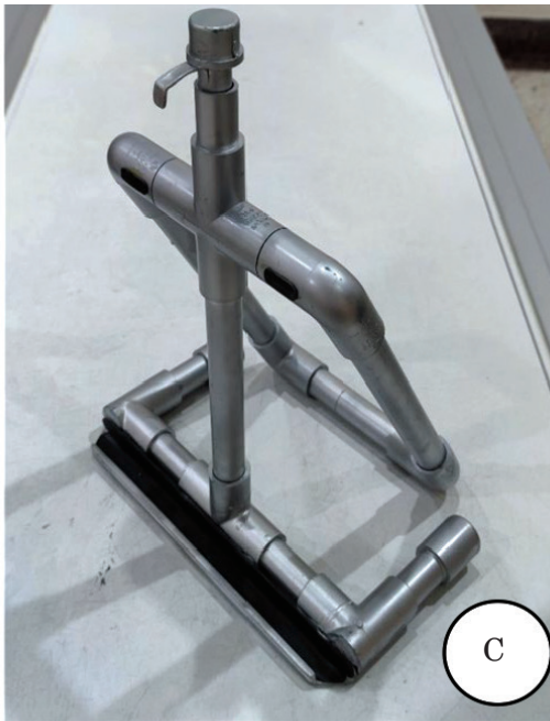
ภาพที่ 7 อุปกรณ์ช่วยยึดแผ่นรับภาพขณะเอกซเรย์โดยใช้ลำรังสีแนวราบ ดังนี้
