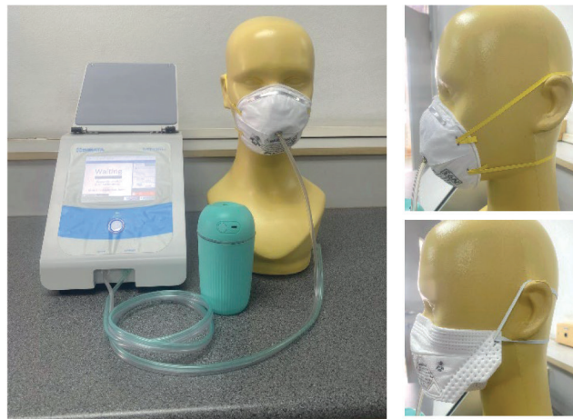
ภาพที่ 2 (ก) การวัด filtration efficiency และ (ข) การวัด fit check ของหน้ากาก N95
