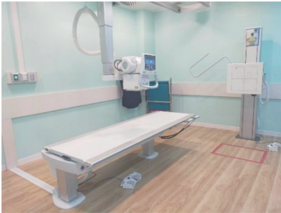
ภาพที่ 1 เครื่องเอกซเรย์ทั่วไประบบดิจิทัลขนาด 1,000 mA (ARCOMA, รุ่น INTUITION) จำนวน 2 ห้อง (ที่มา: โดยผู้วิจัยกลุ่มงานรังสีวินิจฉัยและเวชศาสตร์นิวเคลียร์ โรงพยาบาลมะเร็งอุบลราชธานี)
