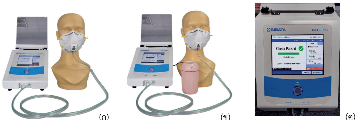
ภาพที่ 4 การทดสอบความกระชับกับใบหน้า (ก) การเชื่อมต่อหน้ากาก N95 เข้ากับเครื่องทดสอบความกระชับใบหน้า (ข) การสร้างละอองโซเดียมคลอไรด์ในบรรยากาศระหว่างการทดสอบความกระชับกับใบหน้า (ค) การแสดงผลการทดสอบบนหน้าจอเครื่องทดสอบความกระชับกับใบหน้า (ที่มา: สำนักวิจัยและเครื่องมือแพทย์ กรมวิทยาศาสตร์การแพทย์)
