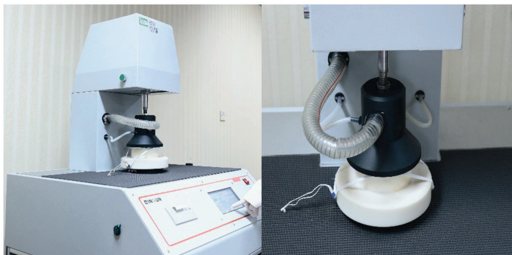
ภาพที่ 3 การทดสอบประสิทธิภาพการกรองอนุภาคด้วยเครื่องทดสอบประสิทธิภาพการกรองอนุภาคของหน้ากาก N95 รุ่น G506 (ที่มา: สำนักวิจัยและเครื่องมือแพทย์ กรมวิทยาศาสตร์การแพทย์)
