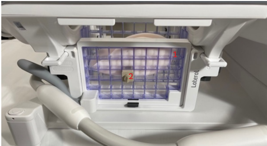
รูปภาพที่ 1 แสดง Breast biopsy coil 7 channel ที่มีช่องเปิดด้านข้างของเต้านมเพื่อประกอบกับ grid (1) ที่มีลักษณะเป็นช่องตารางเล็กๆ สำหรับใส่ needle guide และ fiducial marker (2) ซึ่งเป็นอุปกรณ์ที่ต่อกับ grid เพื่อใช้เป็นหลัก (reference) ในการคำนวณตำแหน่งทางเข้าของเข็มเจาะชิ้นเนื้อ
