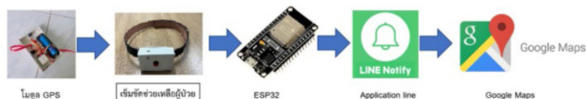
รูปที่ 1 ลักษณะการทำงานของระบบ GPS ของตัวเข็มขัด
