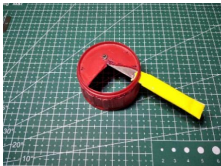
ภาพที่ 1 ฝาดัดสายให้น้ำเกลือ (lid cut infusion) แบบใช้มือโยกตัด
