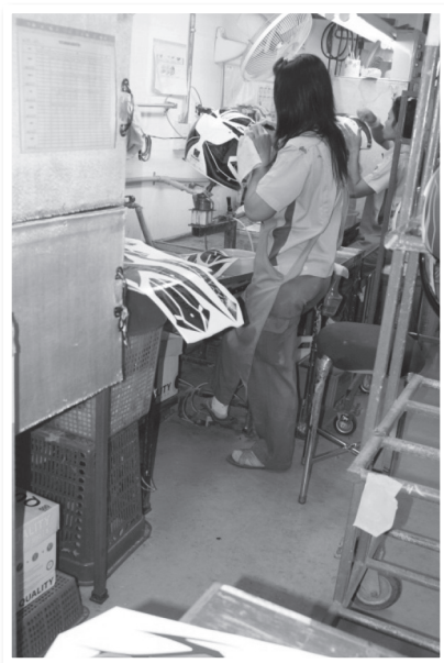
ภาพที่ 2 พนักงานติดสติ๊กเกอร์ ใช้เท้าเหยียบแป้นควบคุมฐานหมุน
