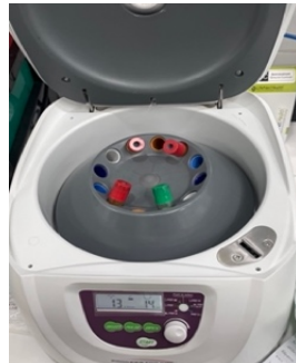
รูปที่ 1 เครื่องปั่น (Duo Quattro, France) ที่ใส่หลอดบรรจุเลือด จำนวน 4 หลอด เลือกปุ่ม A-PRF+ (1,300 rpm, 14 นาที)
