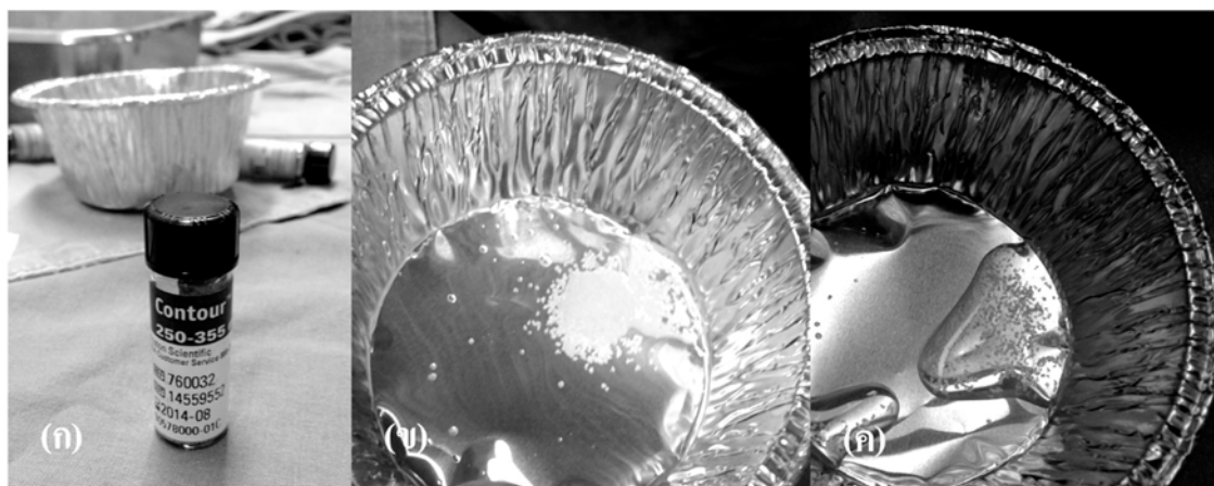
ภาพที่ 3 (ก) แสดง polyvinyl alcohol (PVA) ขนาด 250-355 ไมครอน (ข) ลักษณะของอนุภาคเมื่อเทออกจากขวด (ค) เมื่อใช้งานต้องผสมกับสารทึบรังสีเพื่อให้เป็นสารแขวนลอยก่อน
