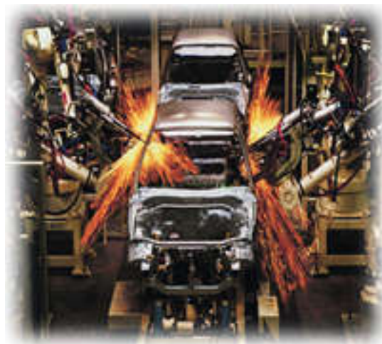
รูปภาพที่ 6 โรงงานอุตสาหกรรมใช้หุ่นยนต์ในการเชื่อมต่อตัวถังรถยนต์ (Gary B. Shelly, 2007)
