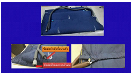
รูปที่ 12 ผ้าห่มพร้อมข้อต่อระบบน้ำเข้า-ออก
