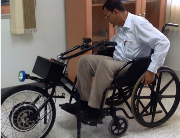
รถสามล้อพลังงานไฟฟ้าแบบหัวลาก
