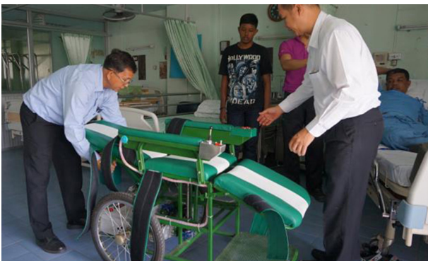
รถเข็นคนพิการระบบไฟฟ้าแบบปรับเปลี่ยน
