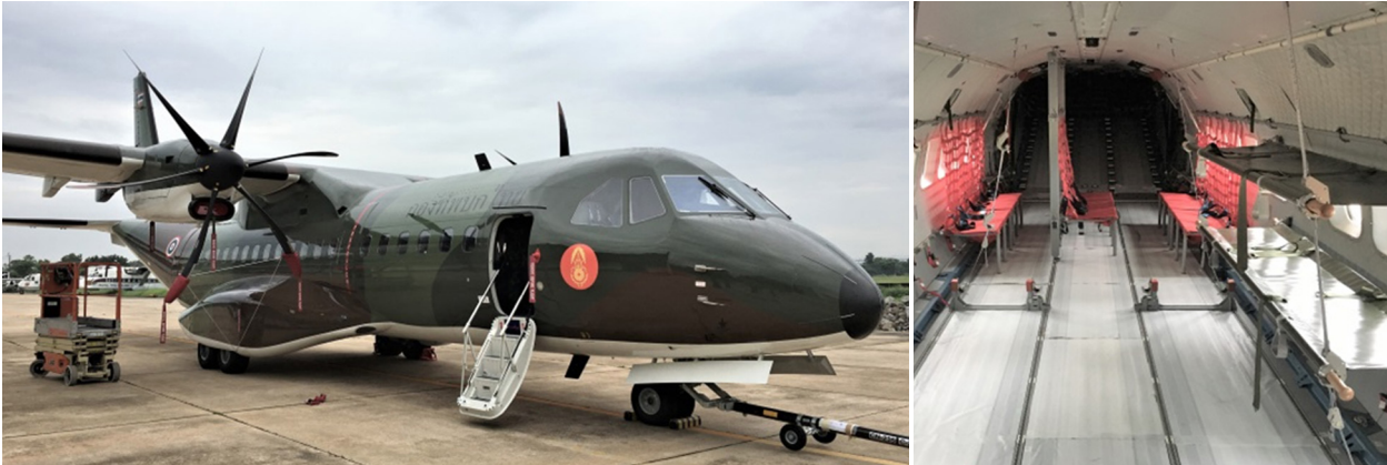
Figure 15 บ.ล.295 (CASA-295W) และห้องโดยสารที่สามารถติดตั้งเปลจำนวนมากได้
