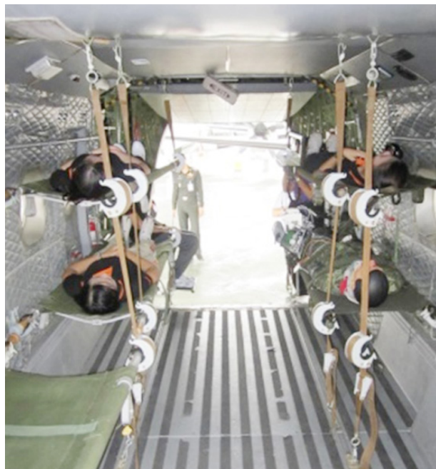
Figure 3 การทดลองติดตั้งเปลบนเครื่องบินลำเลียงแบบ บล. 212
