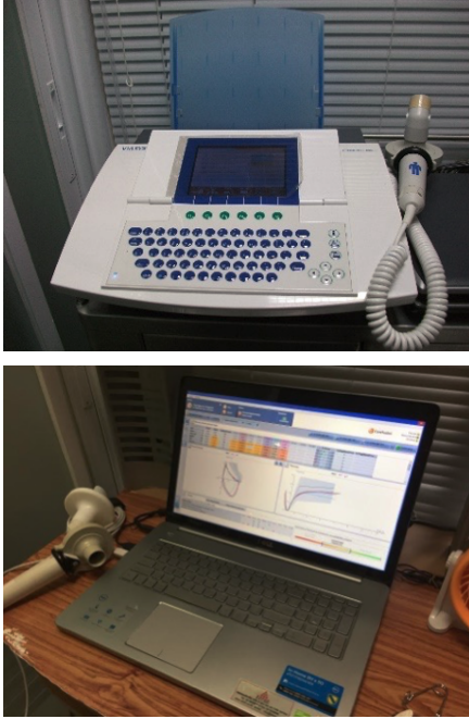
รูปที่ 2. เครื่อง spirometer แบบ การวัดความแตกต่างของความดันสองฝั่ง (differential-pressure pneumotachometer) ที่มา: สมฤทัย ยืนยง
