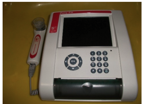
รูปที่ 1. เครื่อง spirometer แบบ การใช้หลักการให้ลมหมุนกังหัน (turbine pneumotachometer) ที่มา: สมฤทัย ยืนยง
