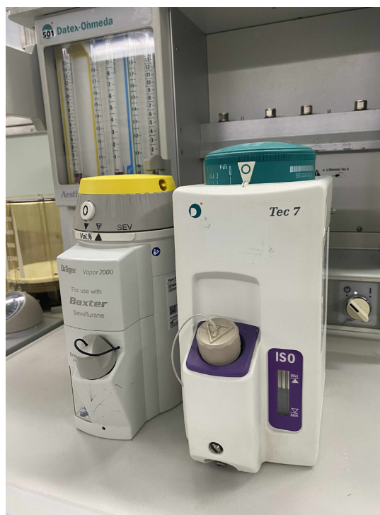
ภาพที่ 6 Vaporizer ชนิด Sevoflurane และ Isoflurane
