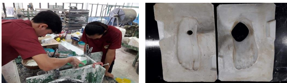
ภาพที่ 6 การสร้างแม่พิมพ์ปูนปลาสเตอร์สำหรับหล่อขึ้นรูป
