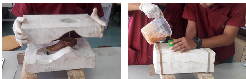
ภาพที่ 7 การหล่อขึ้นรูปชิ้นงานเท้าเทียมต้นแบบ
