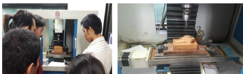
ภาพที่ 5 การป้อนข้อมูล G-code เพื่อกัดขึ้นรูปไม้เนื้อแข็งสร้างแกนเท้าเทียมด้วยเครื่องจักร CNC
