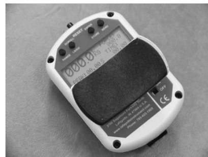
รูปภาพ 1 Hand-held dynamometer ใช้วัดความแข็งแรงของกล้ามเนื้อขาของผู้สูงอายุ
