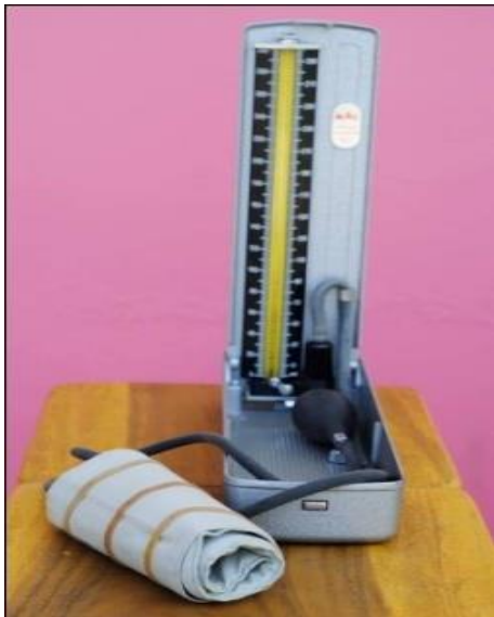
รูปที่ 1 การดัดแปลงส่วนที่ใช้พันรอบต้นแขนของเครื่องวัดความดันโลหิตด้วยมือเป็นอุปกรณ์สำหรับวัดแรงกำมือ
