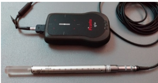
รูปที่ 3 แสดงหัววัดชนิดตัวกลางที่เป็นของแข็ง (CT Dose Profiler probe, CTDP) และอุปกรณ์ multifunction x-ray meter (Black Piranha) (6)
