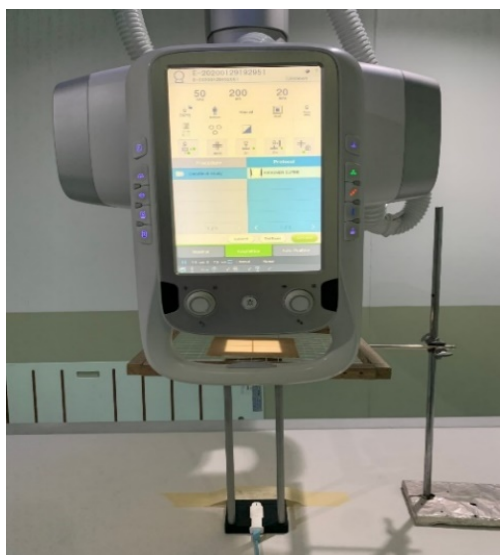
ภาพที่ 2 การจัดวางอุปกรณ์และหัววัดรังสีในการทดสอบรังสีปฐมภูมิ
