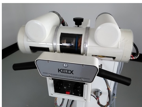
รูปที่ 3 แสดงช่องที่เจาะให้เห็นภายในหลอดรังสีเอกซ์
