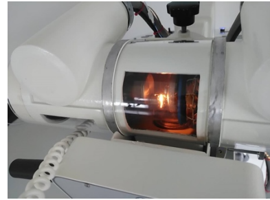
รูปที่ 4 แสดงหลอดรังสีเอกซ์ที่ส่องสว่างเนื่องจากการจุดไส้หลอด และเห็นการหมุนของโรเตตติ้งแอนโนด
