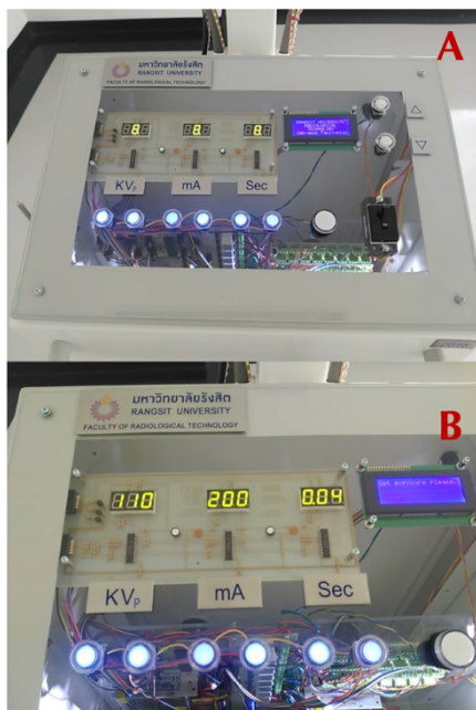
รูปที่ 2A และ 2B แสดงหน้าปัดของเครื่องกำเนิดรังสีเอกซ์เสมือนจริง
