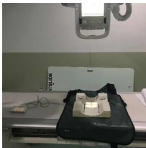
ภาพที่ 5 การวัดปริมาณรังสีเอกซ์ที่ผ่านแผ่นพลาสติก Acrylonitrile butadiene styrene (ABS) ที่ผ่านการขึ้นรูปแล้ว หนา 2 มิลลิเมตร
