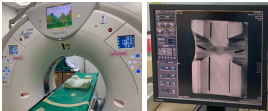
ภาพที่ 7 สแกนอุปกรณ์ยึดตรึงทารถด้วยเครื่องเอกซเรย์คอมพิวเตอร์
