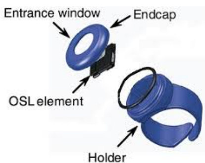
ภาพที่ 3 แหวนสำหรับใส่แผ่นวัดรังสีโอเอส แอลชนิดนาโนดอท
