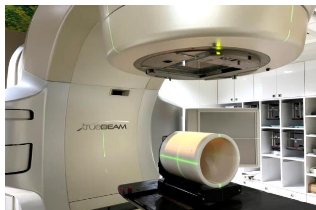
รูปที่ 3 Isocal phantom และการเตรียมอุปกรณ์ในการวัด output
