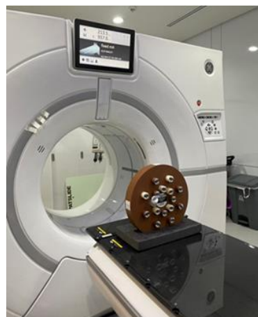
รูปที่ 3. การเก็บภาพ CT Electron Density Phantom ด้วยเครื่องเอกซเรย์คอมพิวเตอร์ ยี่ห้อ GE
