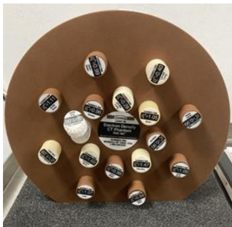
รูปที่ 2. CT Electron Density Phantom – Gammex
