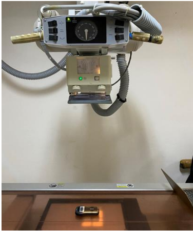
รูปที่ 1. แสดงการจัดหัววัดรังสีชนิด Piranha จากเครื่องเอกซเรย์ยี่ห้อ Toshiba รุ่น KXO-32S เพื่อวัดค่า X-ray tube output
