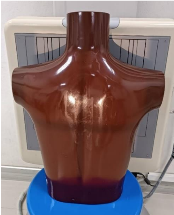
รูปที่ 2 แสดงตัวอย่างหุ่นจำลองส่วนทรวงอก (Chest Phantom: Thorax phantom RSD 311)
