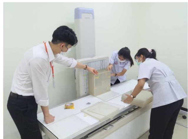
รูปที่ 2 ภาพการจัดตำแหน่ง V-shaped line gauge phantom ประกอบรวมกับ acrylic solid water phantom เพื่อจำลองการถ่ายภาพเอกซเรย์ปอด
