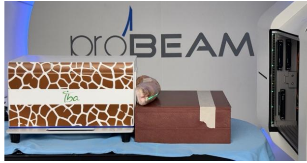
รูปที่ 2 การจัดวางชุดทดลอง (Set-up) สำหรับการวัดระยะหยุดของอนุภาคโปรตอน (Proton range) ในตัวอย่างเนื้อเยื่อหมู (pig tissue) โดยใช้เครื่องวัดปริมาณรังสี Giraffe dosimeter ภายในห้องฉายรังสีของเครื่องโปรตอน Varian ProBeam
