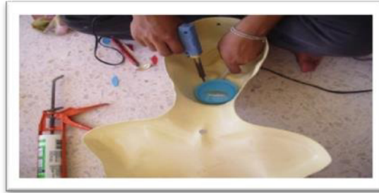
ภาพที่ 3 การเชื่อมฝากระป๋องพลาสติกให้ติดกับปากของหุ่นจำลอง
