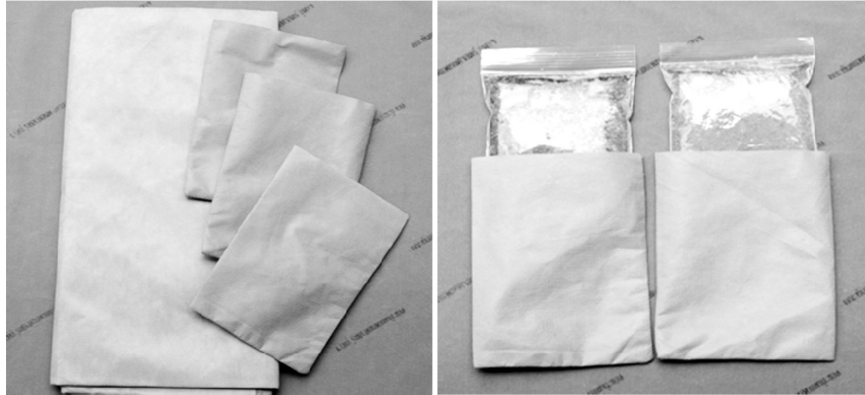
ภาพที่ 3 เจลที่แบ่งใส่ถุงพลาสติกซีลปิด แล้วหุ้มด้วยถุงที่ตัดเย็บจากผ้าไมัดักทอ
