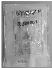
รูปที่ 3 เม็ด FPMMA beads ที่ผ่านกระบวนการทำไ้เชื้อด้วยวิธีการอบแก๊ส Ethylene oxide แล้ว
