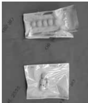
รูปที่ 2 เม็ด FPMMA beads หลังจากปั้นเป็นเม็ดกลม บรรจุในบรรจุภัณฑ์
